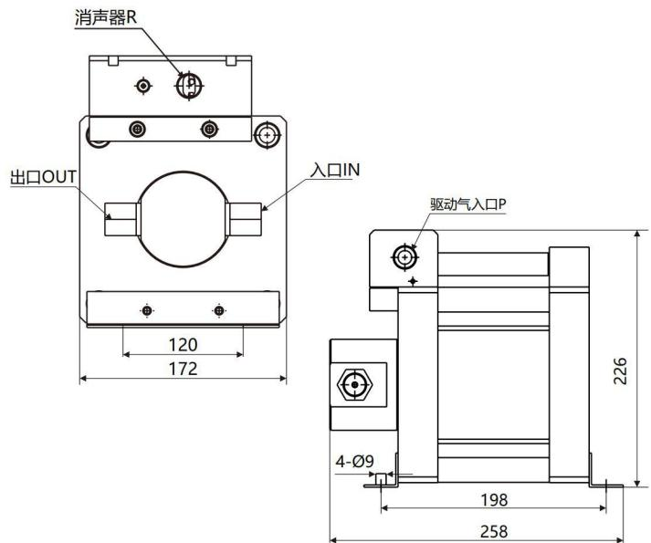
SWB-160S系列泵为单驱动头单作用气液增压泵，采用单气控非平衡气体分配阀来实现泵的自动往复运动。驱动活塞直径为160mm，泵体气驱部分全部采用铝合金制造并表面经过阳极氧化处理，泵的全套密封件均采用进口密封件，从而保证了产品的外形美观及耐用性。
